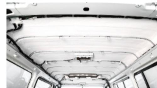
最も熱を受けやすいルーフに、丁寧に断熱材をはめていきます。なるべく隙間の出来ないように施工します。
