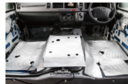
運転中に気になるエンジンルームからの熱を和らげる新商品、『ヒートインシュレーションマット』を採用。快適なドライブを約束します。
