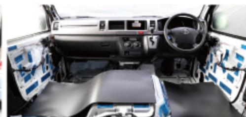
主に運転席・助手席着座時に効果を感じる Phase II。フロントスピーカー裏には音質を向上させるディフュージョンも施工しています。
